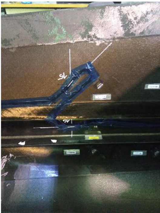
Figura 6. Detalle de la red sensora de FBGs pegada en el interior del fuselaje
