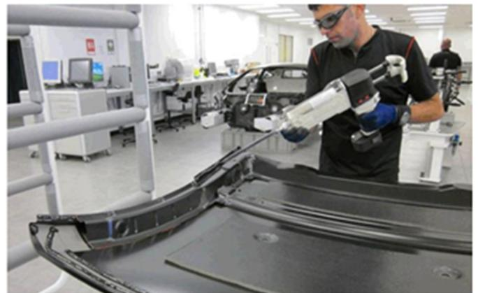
**Figura 16.** Ejemplo de aplicación en Automoción de unión de material compuesto a metal con adhesivo estructural bi-componente 3M™ Scotch-Weld™ base epoxi (flexible, curado lento)
