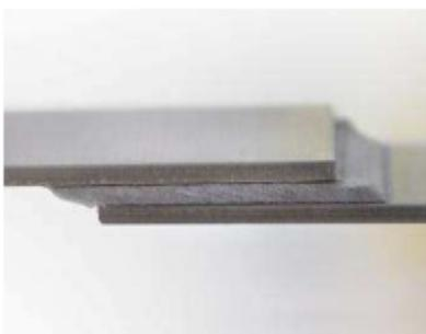
**Figura 18.** Visco-elasticidad de las espumas acrílicas 3M™ VHB™ aplicadas a materiales compuestos
