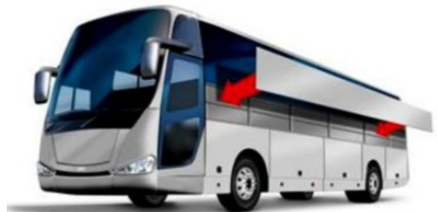
Figura 2. Pegado a marco de paneles de aluminio compuesto exteriores de un autobús con cintas de espuma acrílica 3M<sup>TM</sup> VHB<sup>TM</sup>
