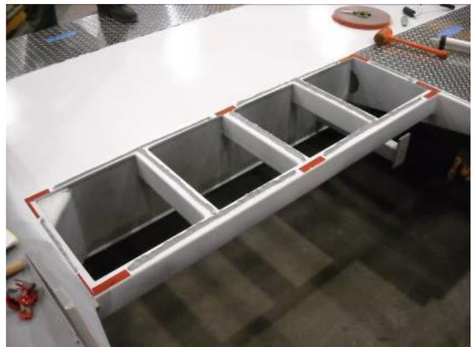
**Figura 23.** Ejemplo de aplicación con unión híbrida 3M™ VHB™ y Adhesivo Estructural 3M™ Scotch-Weld™
