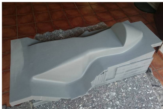
Figura 7. Modelo fabricado en MDF mediante mecanizado CNC.
