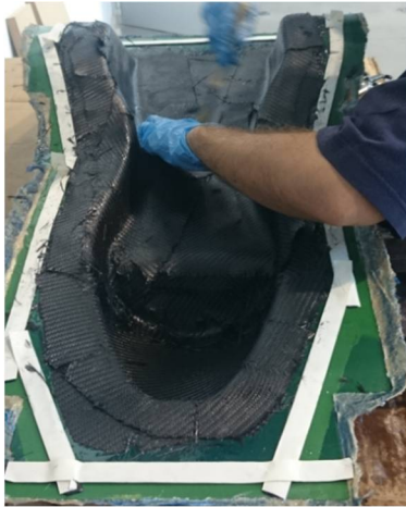
Figura 9. Laminado del colín de carbono.
