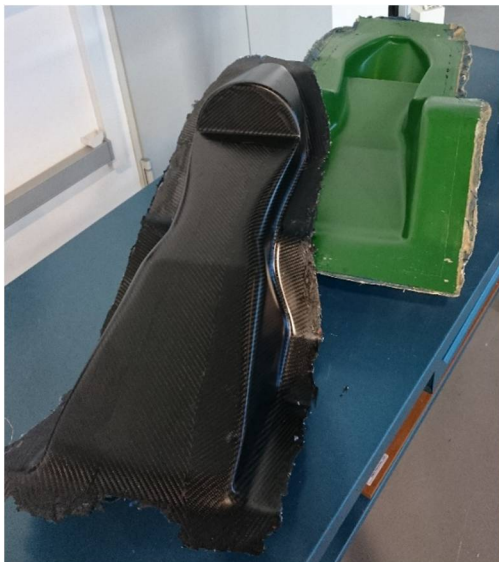
Figura 11. Pieza final antes de recantado.
