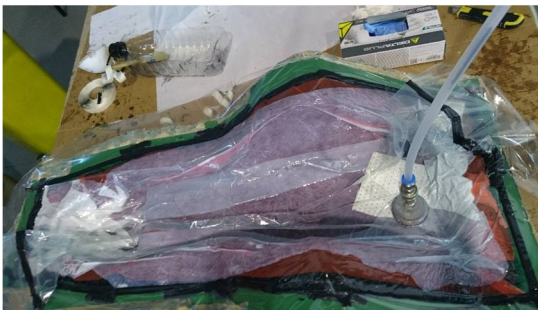
Figura 10. Compactado mediante bolsa de vacío.
