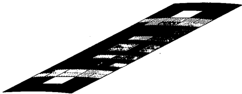
Figura 11. Distribución de tensiones \sigma_{yz} en lámina de mat.
