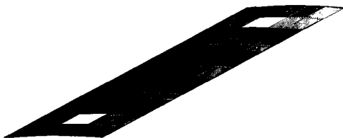
Figura 5. Distribución de tensiones \sigma_x en lámina de mat.
