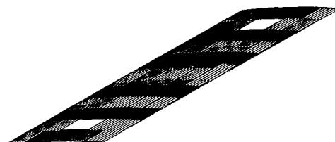
Figura 4. Distribución de tensiones \sigma_x en lámina de tejido.
