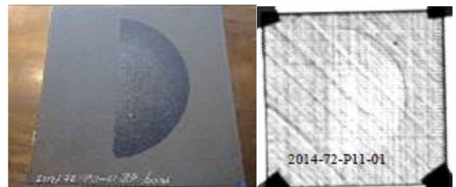
Figura 7. Ejemplo panel curado con Velos dopados y su C-Scan
