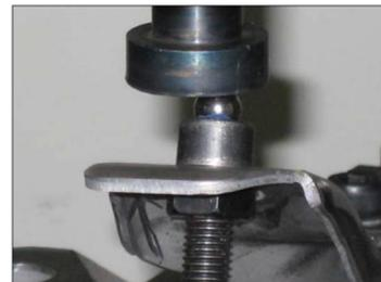
Figura 3. Punto de aplicación de la carga en el ensayo "colapso de freno suelto".
