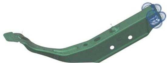
Figura 4. Condiciones de contorno aplicadas en el modelo de elementos finitos del pedal.
