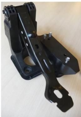
Figura 1. Pedal de freno en acero.
