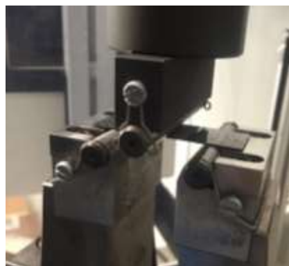
Figura 10. Ensayo de flexión de una probeta con velo de PA6.
