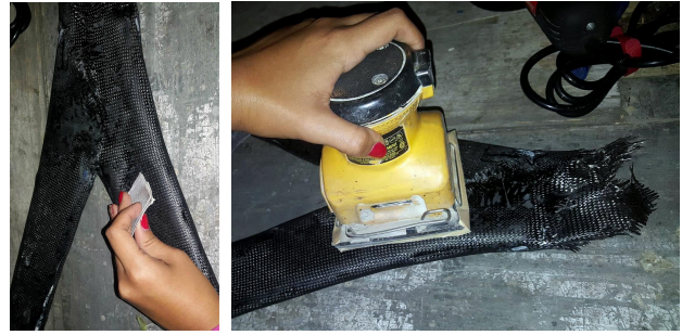
Figura 50. Proceso de lijado para eliminar exceso de resina en la pieza (a) manual, (b) con la ayuda de lijadora manual.
