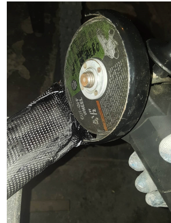
Figura 51. Recorte de excedentes en la pieza.
