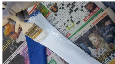
Figura 22. Aplicación de gelcoat en modelo.
