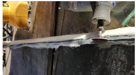
Figura 35. Remoción de material sobrante en el molde.
