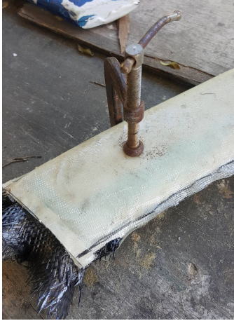
Figura 48. Molde con prensas en C.
