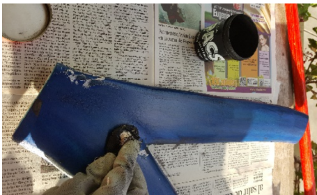
Figura 19. Aplicación de cera desmoldante con estopa.
