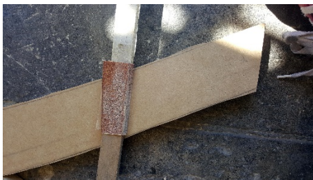
Figura 13. Pieza de MDF en proceso de lijado.
