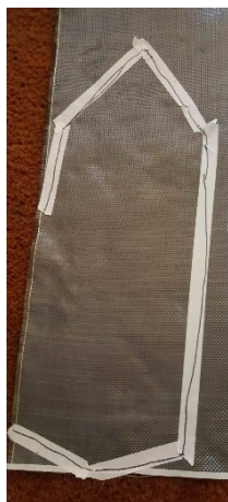
Figura 43. Delineado de plantillas con tape.
