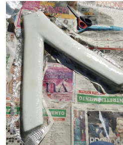
Figura 28. Impregnación de resina poliéster en fibra de vidrio.
