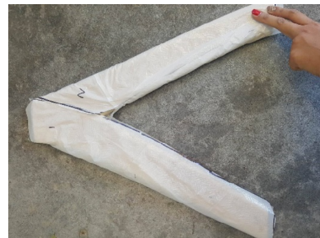
Figura 41. Plantilla para fibra marcada y recortada.
