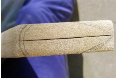
Figura 12. Trazo de perfiles en la horquilla.
