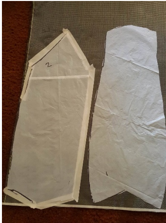
Figura 42. Colocación de plantillas sobre fibra d carbono.
