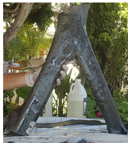
Figura 47. Modelo al finalizar la aplicación de fibra de carbono y resina epoxica.
