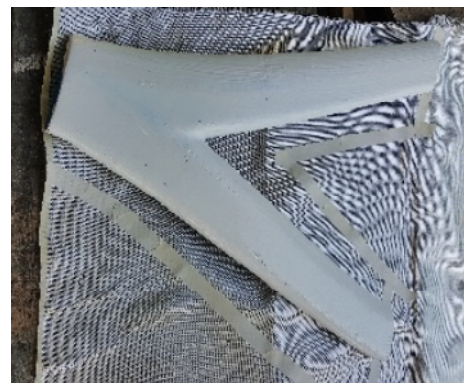
Figura 23. Aplicación de tape y delimitado con marcador.
