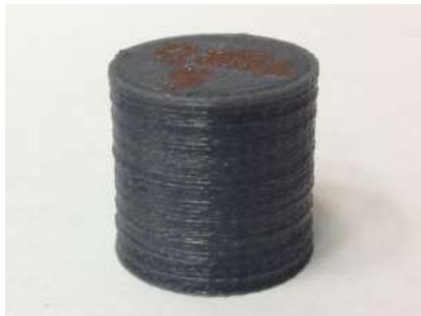
**Figura 2.** Cilindros de ABS reforzado con 0,25% NLC, fabricados con la impresora 3D SIRIUS para ser ensayados a compresión.
