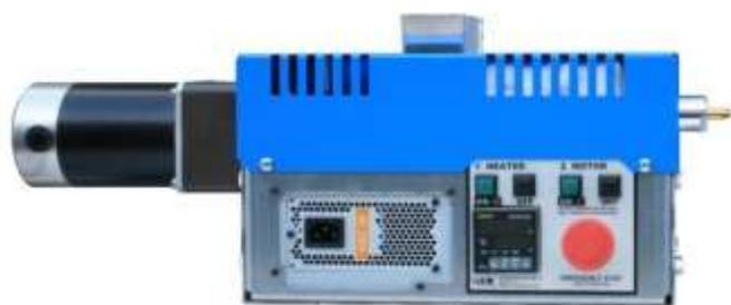
**Figura 1.** Extrusora modelo FilaFab Pro 350 EX empleada para la fabricación del filamento ABS reforzado con nanoláminas de carbono.
