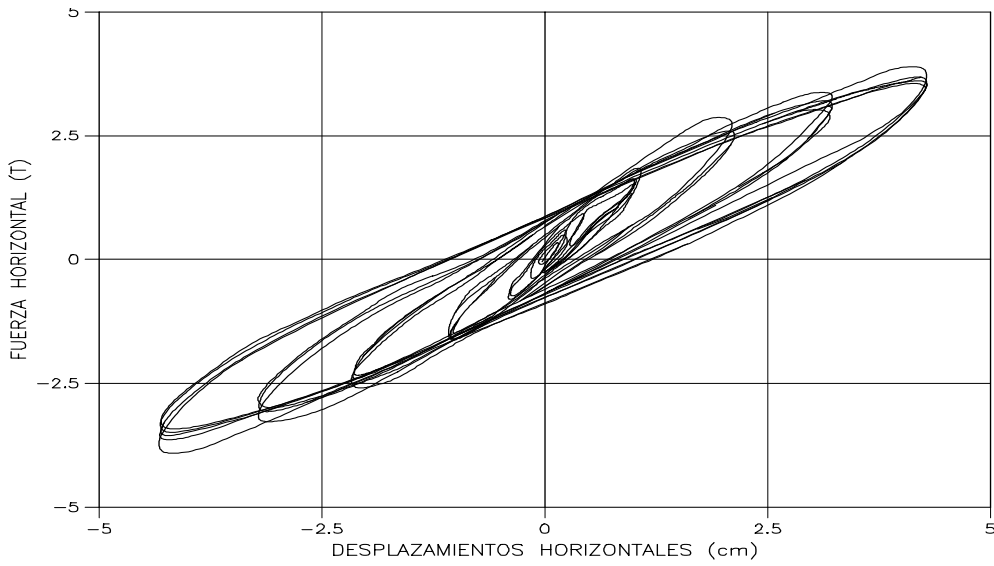
Figura 2.21 Diagrama fuerza-desplazamiento horizontal para carga vertical nula y deformaciones \gamma = \pm 5\% - \pm 100\% (Kelly, 1991).
