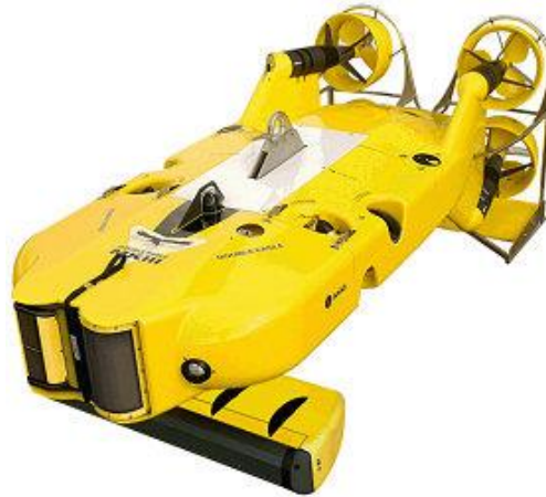
Figura 1-15: Double Eagle desarrollado por SAAB, trabaja como AUV o como ROV.
