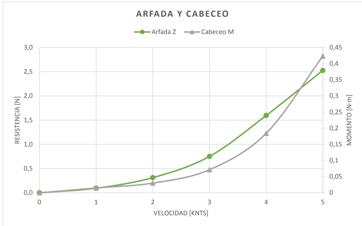
Figura 7-1: Gráfica Resistencia de Momento de cabeceo y Fuerza de sustentación vehículo moviéndose en X.
