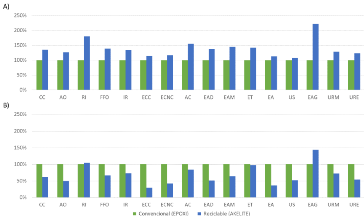
Figura 4. Comparativa de resultados de Huella Ambiental de la etapa de manufactura (gráfica A) y del ciclo de vida (gráfica B). Cambio climático (CC), Agotamiento de la capa de ozono (AO), Radiación ionizante (RI), Formación fotoquímica de ozono, (FFO) Inorgánicos respiratorios (IR), Efectos no cancerígenos en la salud humana (ECC), Efectos cancerígenos en la salud humana (ECNC), Acidificación terrestre y de agua dulce (AC), Eutrofización del agua dulce (EAD), Eutrofización de agua marina (EAM), Eutrofización terrestre (ET), Ecotoxicidad agua dulce (EA), Uso del suelo (US), Escasez de agua (EAG), Utilización de recursos, vectores energéticos (URM), Utilización de recursos, minerales y metales (URE).
