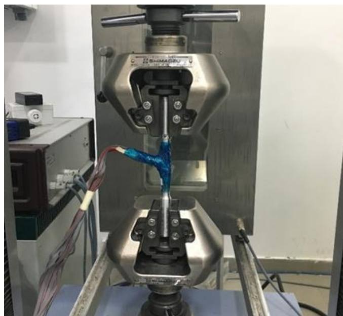
Figura 4. Proceso de verificación de alineamiento con probeta.
